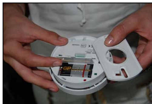
Obr.: Autonomní hlásič kouře (detail) – napájení baterií
